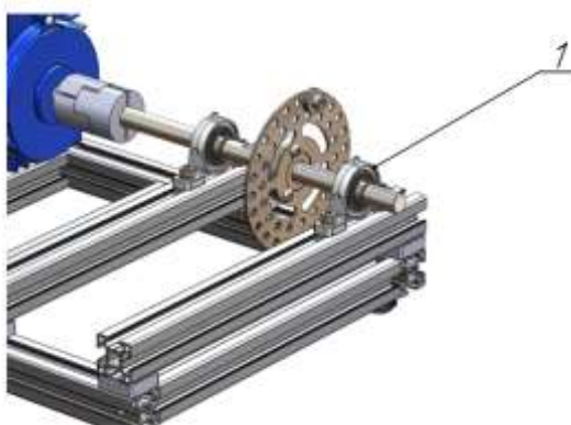
Рисунок 22 – Конфигурация №5 «Дефектный подшипник»
