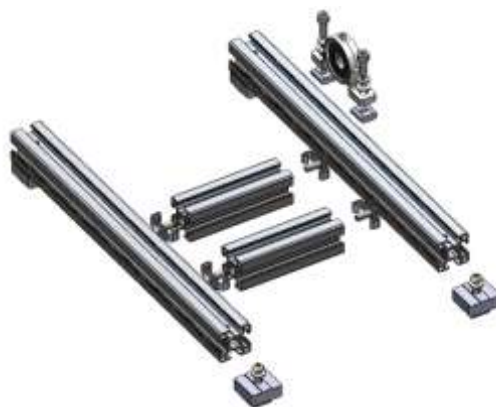
Рисунок 14 – Схема сборки рамы для конфигурации №2 «Коническая зубчатая передача»
